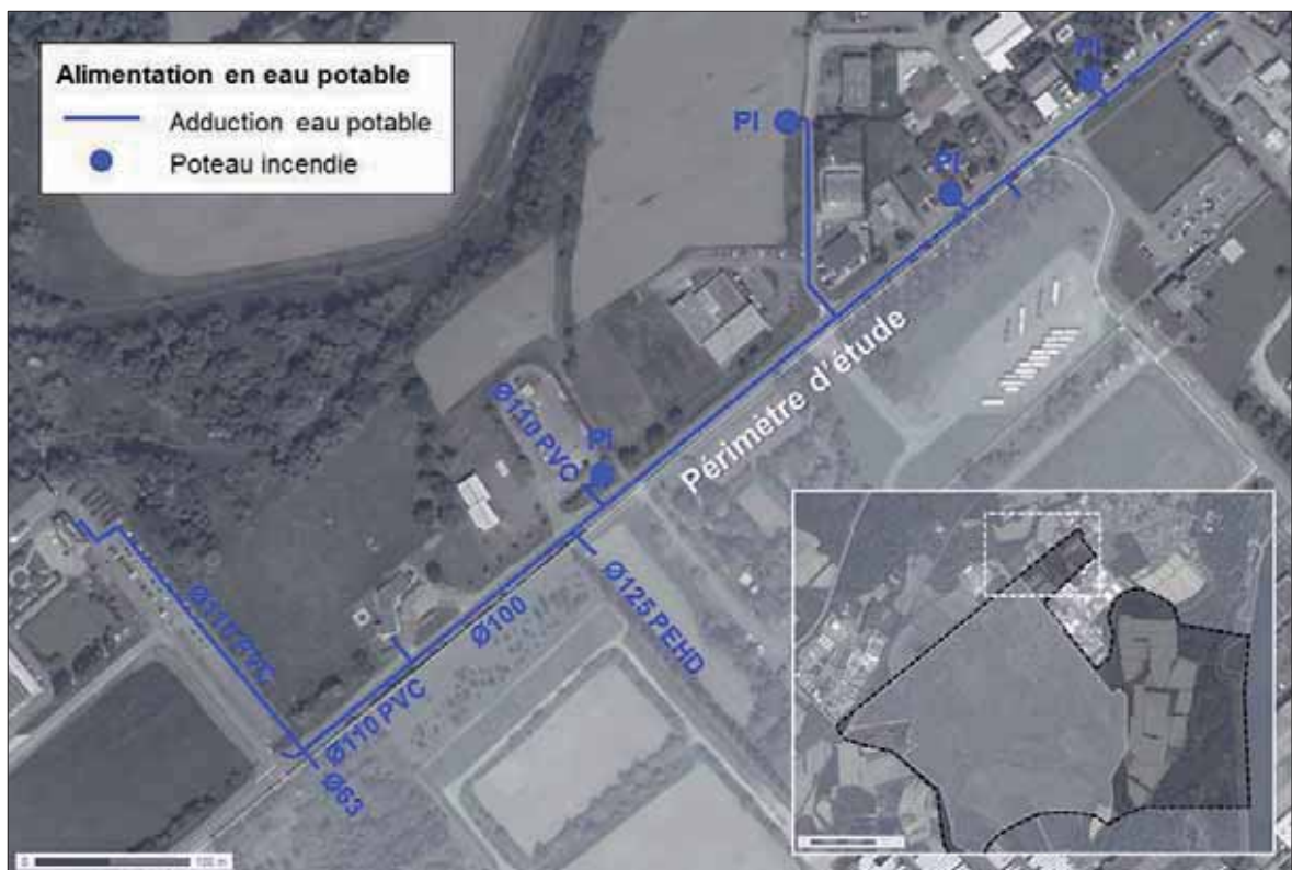
Fig. 152. Plan des réseaux d'eau potable
