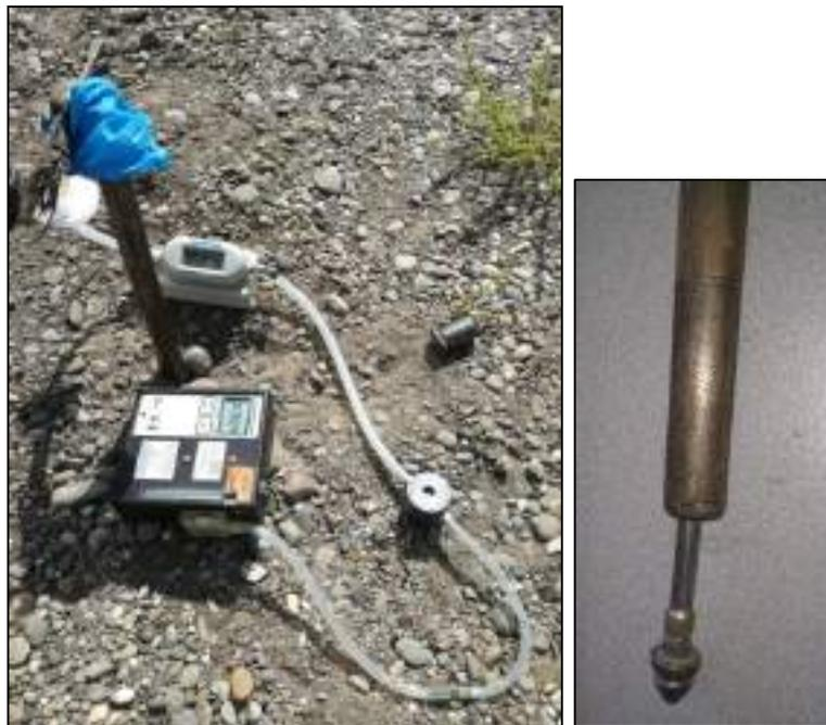
**Fig. 16. Système de pompage par canne gaz (gauche) et pointe perdue (droite)**
