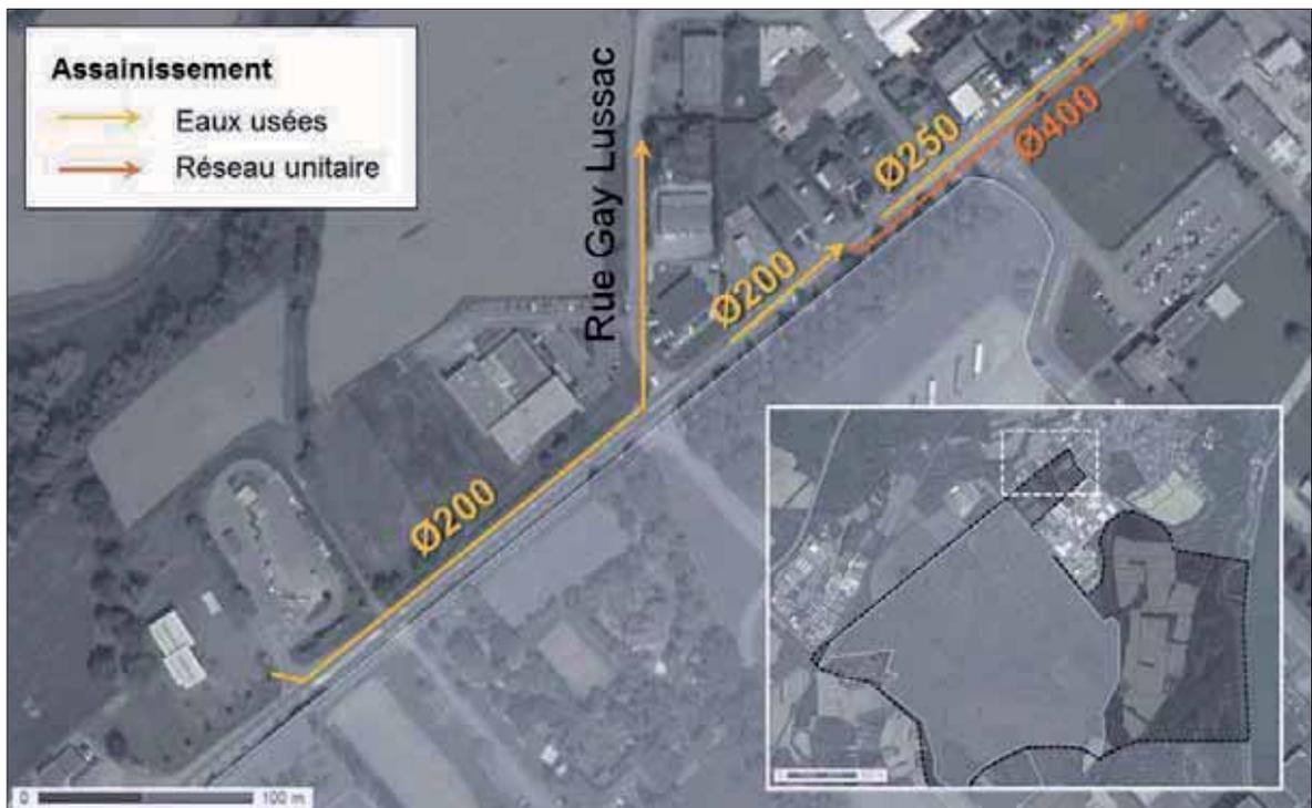
**Fig. 28. Plan des réseaux d'assainissement**
