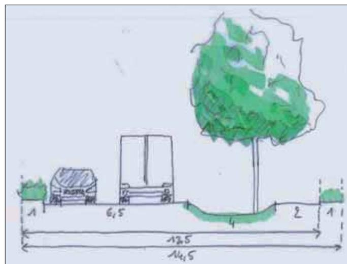
**Fig. 51. Voiries tertiaires - Profil F**
