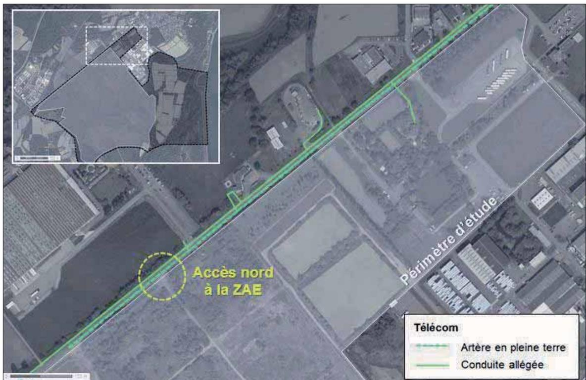
**Fig. 25. Plan des réseaux Télécom**
