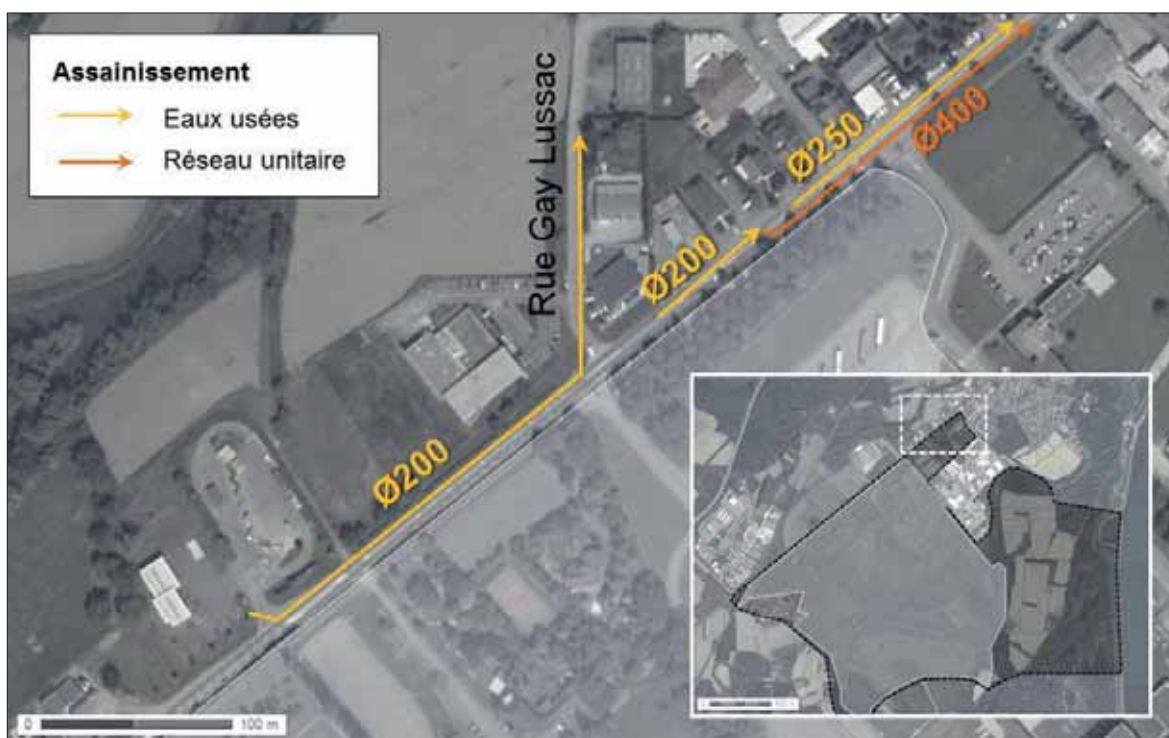
Fig. 24. Plan des réseaux d'assainissement
