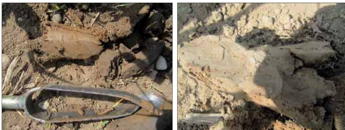
Fig. 169. Horizon redoxique (Pseudogley) à gauche - Horizon réductique (Gley) à droite
