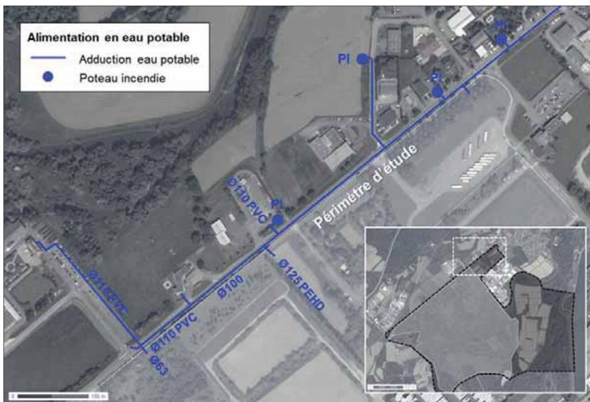
Fig. 152. Plan des réseaux d'eau potable
