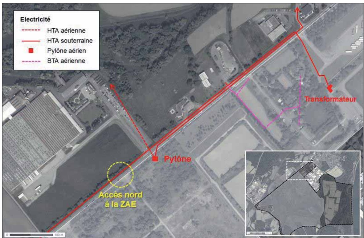
Fig. 20. Plan des réseaux électriques
