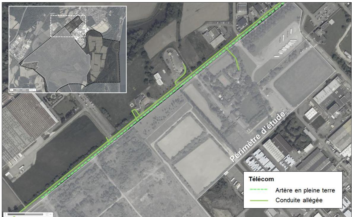
**Fig. 29. Plan des réseaux Télécom**
