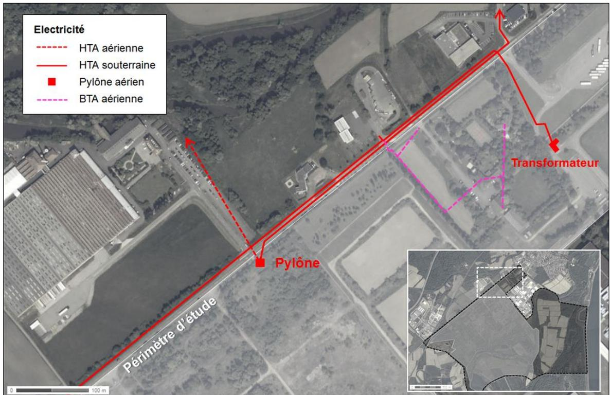
**Fig. 28. Plan des réseaux électriques**
