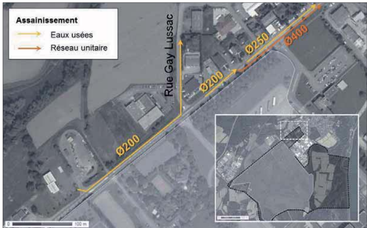
Fig. 28. Plan des réseaux d'assainissement
