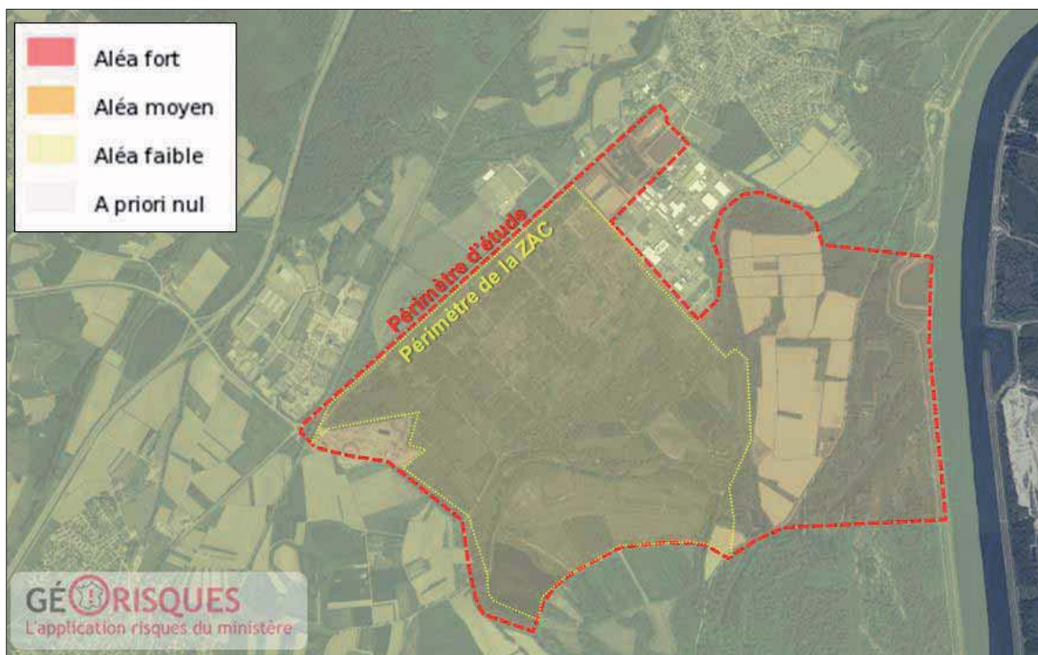
Fig. 140. Aléa retrait-gonflement des argiles (source : www.georisques.gouv.fr )
