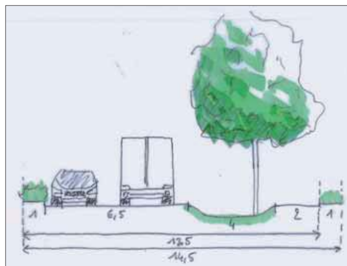
Fig. 51. Voiries tertiaires - Profil F
