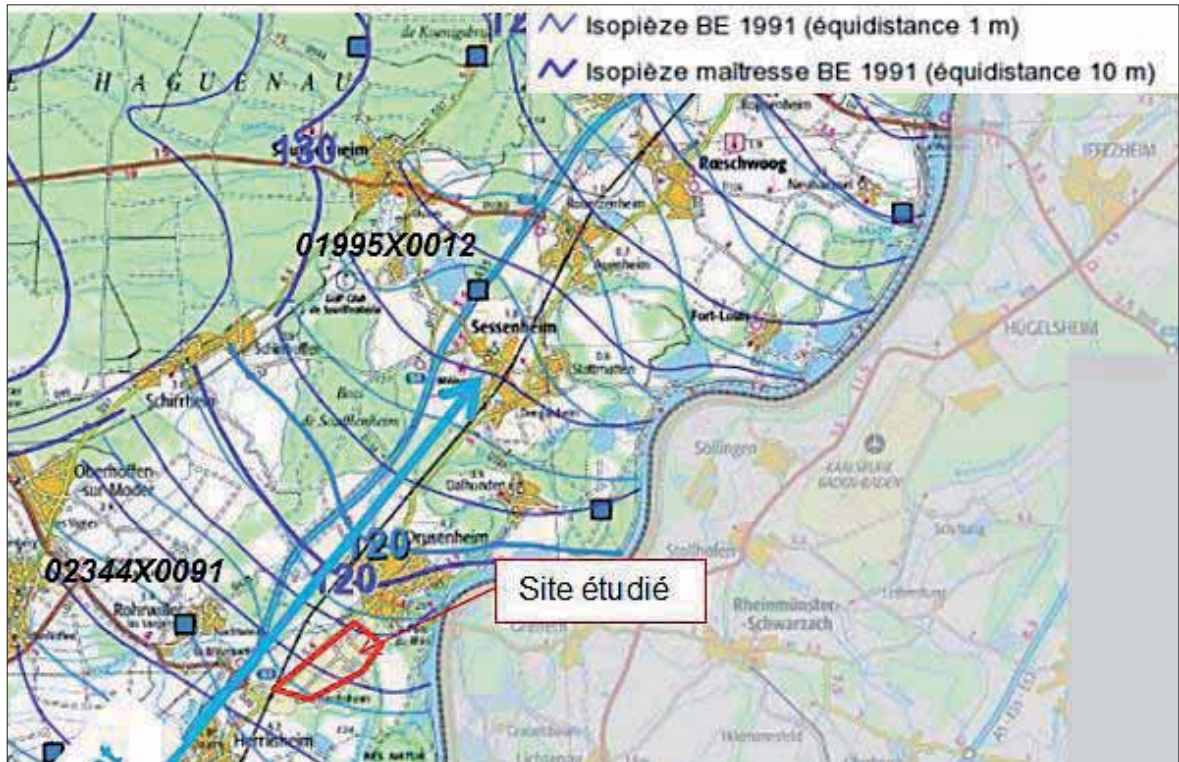
Fig. 61. Zoom sur le piézomètre de Sessenheim et l'anomalie visible sur les isopièzes
