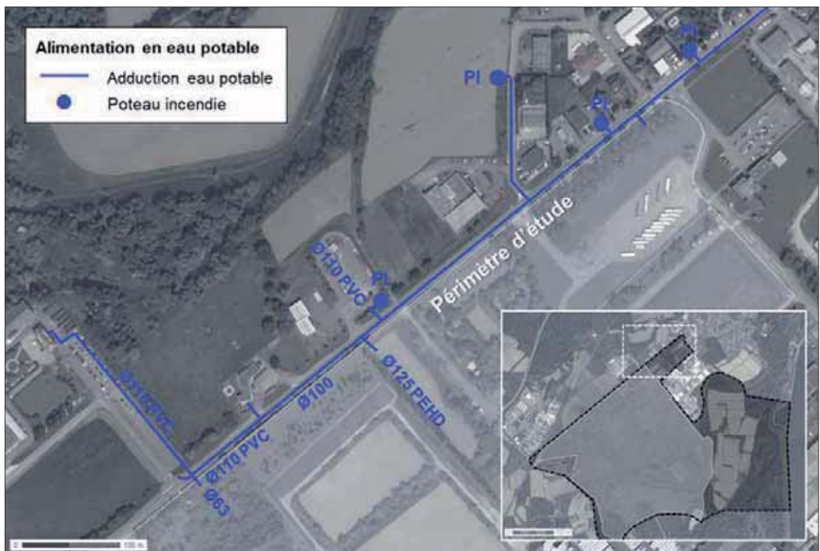
Fig. 148. Plan des réseaux d'eau potable
