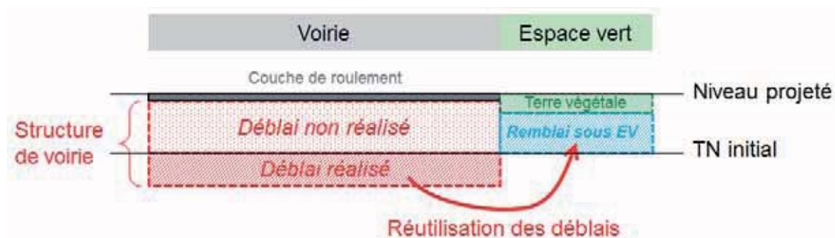
Fig. 20. Schéma de principe du rehaussement et de la réutilisation des déblais
