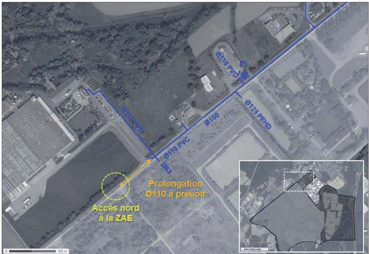
Fig. 26. Plan des réseaux d'eau potable
